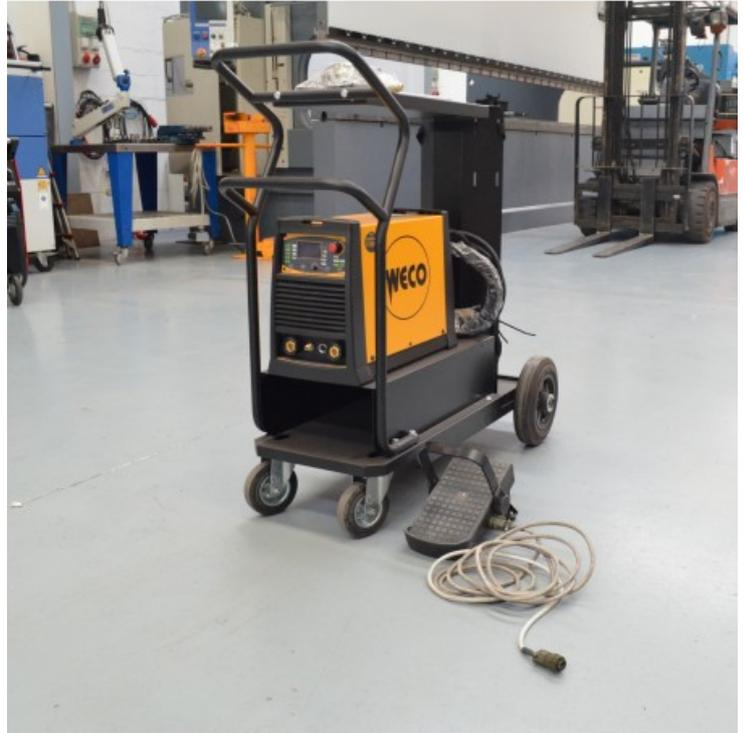
Es posible hacer el cambio de polaridad automático de las tomas de salida directamente desde el panel frontal para evitar mover los cables de soldadura.
