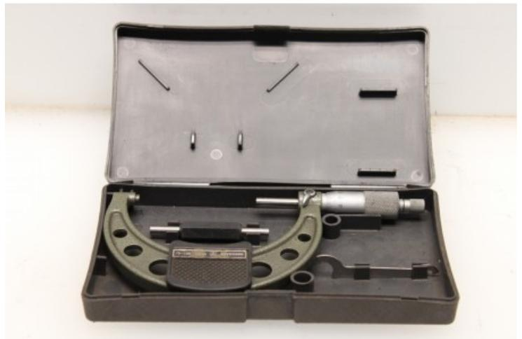
Micrómetro de exteriores analógico
