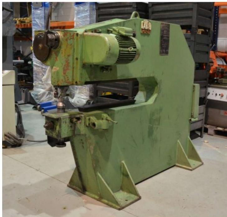
Corte chapa sin perforación previa: 6,3mm (Acero)
